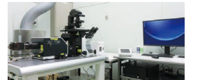
共用機器センターで共同利用できる超解像顕微鏡システム The confocal super-resolution system shared at Research Equipment Sharing Center
